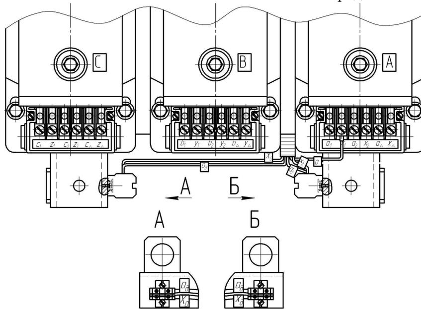
Рисунок А.13 Маркировка вводов трансформаторов напряжения трехфазной
