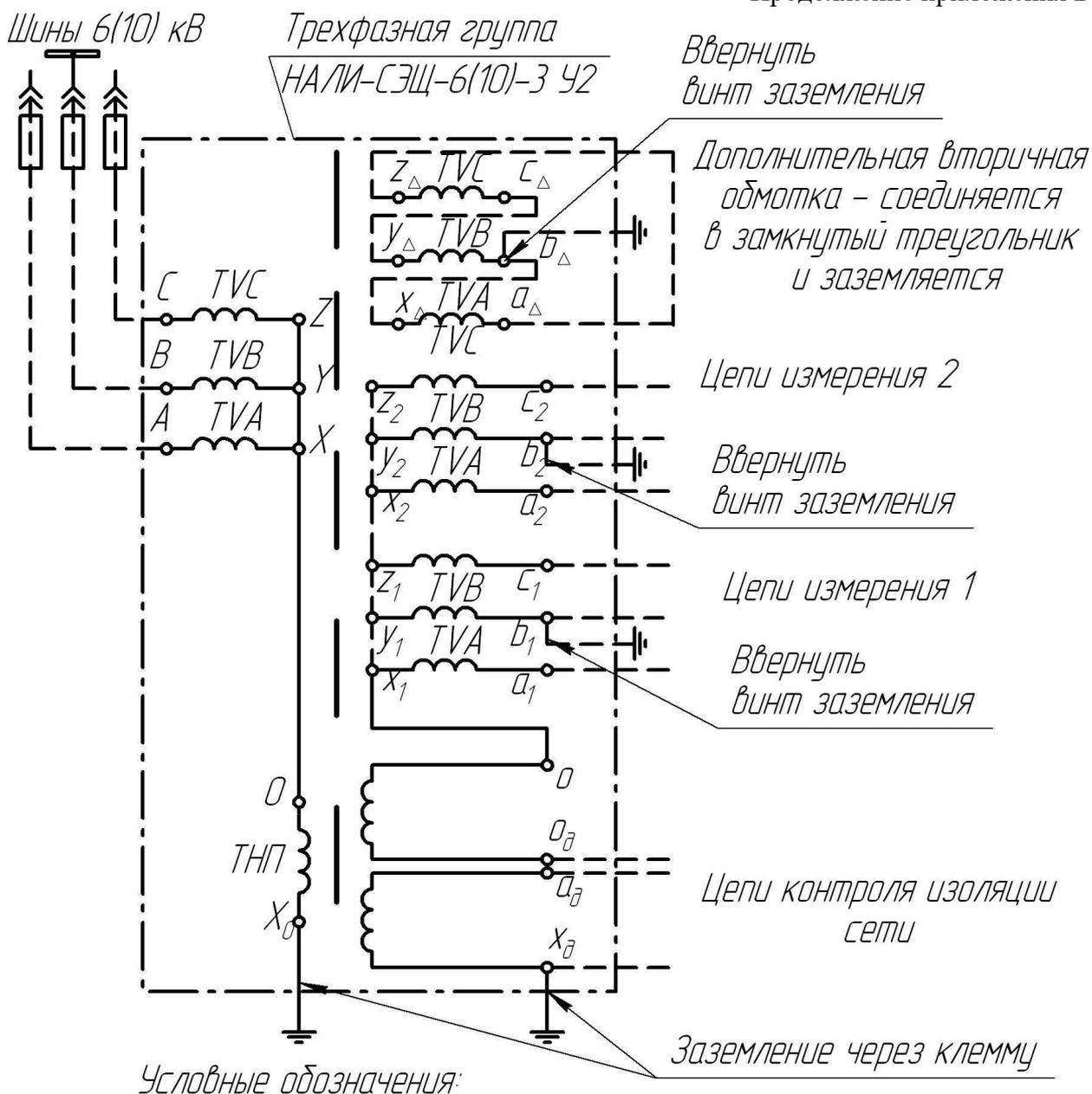
Рисунок Б.10 Принципиальная электрическая схема соединения обмоток трансформаторов напряжения трехфазной антирезонансной группы НАЛИ – СЭЩ – 6(10) – 3 с тремя вторичными обмотками
