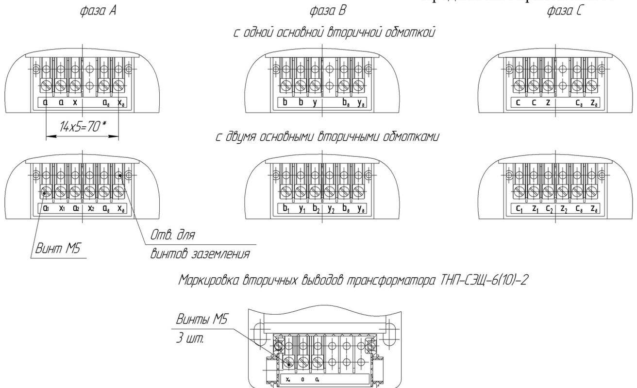
Рисунок А.14 Маркировка вводов трансформаторов напряжения трехфазной антирезонансной группы НАЛИ – СЭЩ – 6(10) – 21(26) с двумя и тремя вторичными обмотками
