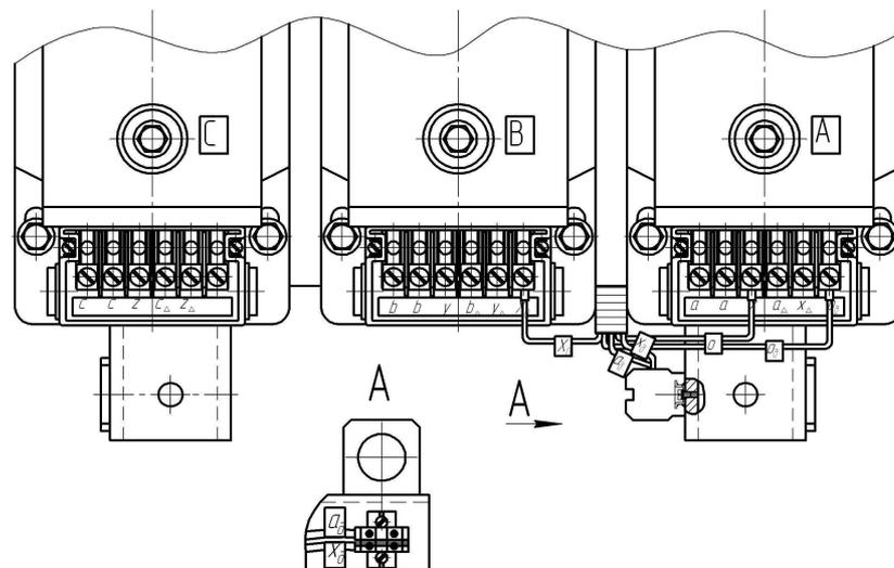
Рисунок А.12 Маркировка вводов трансформаторов напряжения трехфазной антирезонансной группы НАЛИ – СЭЦ – 6(10) – 3
