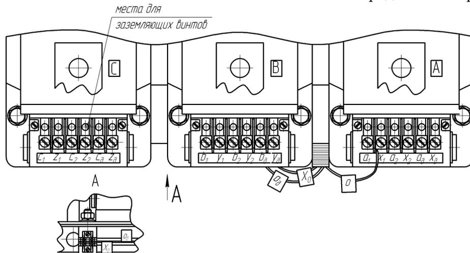
Рисунок А.11 Маркировка вводов трансформаторов напряжения трехфазной антирезонансной группы НАЛИ – СЭЦ – 6(10) – 11, (14, 16) с тремя вторичными обмотками
