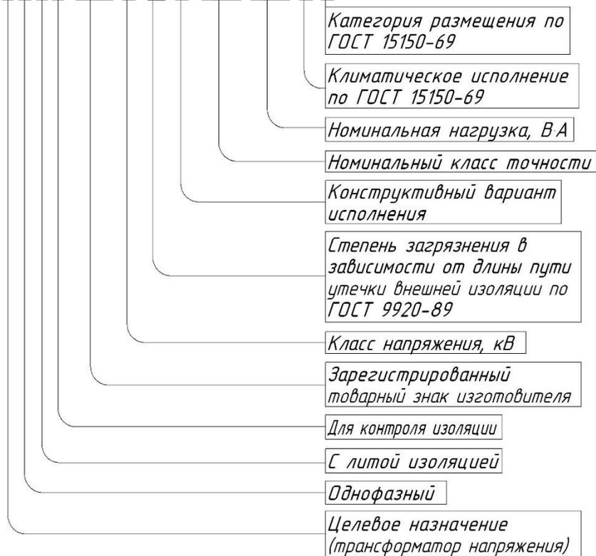
Пример записи обозначения трехфазной группы трансформаторов напряжения конструктивного исполнения 26, класса напряжения 6 кВ с обмоткой для подключения цепей измерения с классом точности 0,5 и нагрузкой 150 В·А, климатического исполнения «У», категории размещения 2 по ГОСТ 15150 при его заказе и в документации другого изделия:
