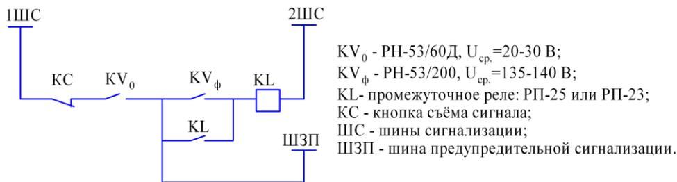
Рисунок 5 Автоматическая схема оперативных цепей защиты от феррорезонансных процессов.
